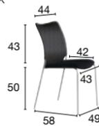
Structure 4 pieds en **tube métallique** Ø 22 mm
