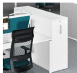
Rangement de proximité et séparation des postes de travail. Structure mélamine ép 19 mm. Tiroir façade extraction totale, préhension par poignée métallique gris aluminium. Système d'ouverture silencieux. Fermeture centralisée équipée d'une serrure à barillet (2 clés fournies). Caisson hauteur bureau équipé d'une tablette mélamine, caisson H. 113,5 cm équipé de 2 tablettes mélamine. L. 43,2 x P. 80 cm. Produit livré assemblé.
